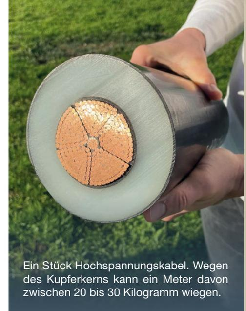
Ein Stück Hochspannungskabel. Wegen des Kupferkerns kann ein Meter davon zwischen 20 bis 30 Kilogramm wiegen.
