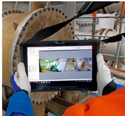
Live-Video-streaming im Rahmen einer Leckageortung an einem Wärmetauscher am Standort Böhlen
