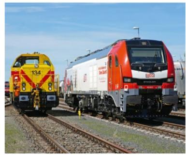
Die Hybridlok (links) ähnelt eher einem Hybrid-Pkw, da sie im Dieselmotor und mit Strom aus einer Batterie fahren kann. Sie hat keinen Anschluss zur Oberleitung. Eine Dual-Mode-Lok (rechts) kann auf Strecken elektrisch gefahren werden, die mit Oberleitungen ausgestattet sind. Bei Strecken ohne Oberleitung steht ein leistungsstarker Dieselmotor zur Verfügung. Somit ist gewährleistet, dass so viel wie möglich elektrisch gefahren werden kann und kein Lokwechsel notwendig wird.
