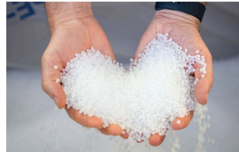
Bei der Kunststoffproduktion entstehen wenige Millimeter große Granulate. Diese lassen sich gut zu den Kunden transportieren, die daraus dann viele Anwendungen herstellen.
